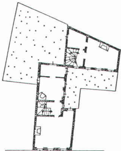
Rekonstruktionsskiss av våning 1 tr år 1746, med 5 rum och 2 trätrappor.
