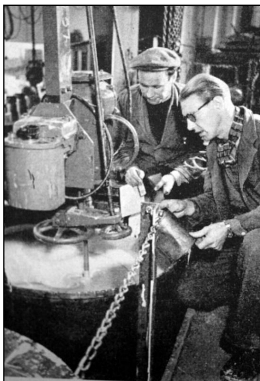
Nyansering av en ugnslack i färgfabriken, 1950-tal. Nyanseringen är ett viktigt moment i färgtillverkningen. Ofta hade företag som Electrolux och LM Ericsson speciella kulörer på sina produkter. (Ur Beckers arkiv)
