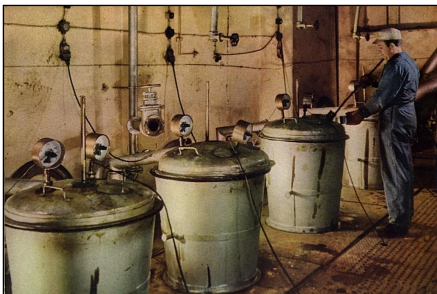
Lackkokning i "Smälten", 1940-tal. Kockärnen har nu fått utsug, termometrar och gasdrift. Arbetet krävde stor noggrannhet och vana. (Foto ur Vi på Beckers, 1949)
