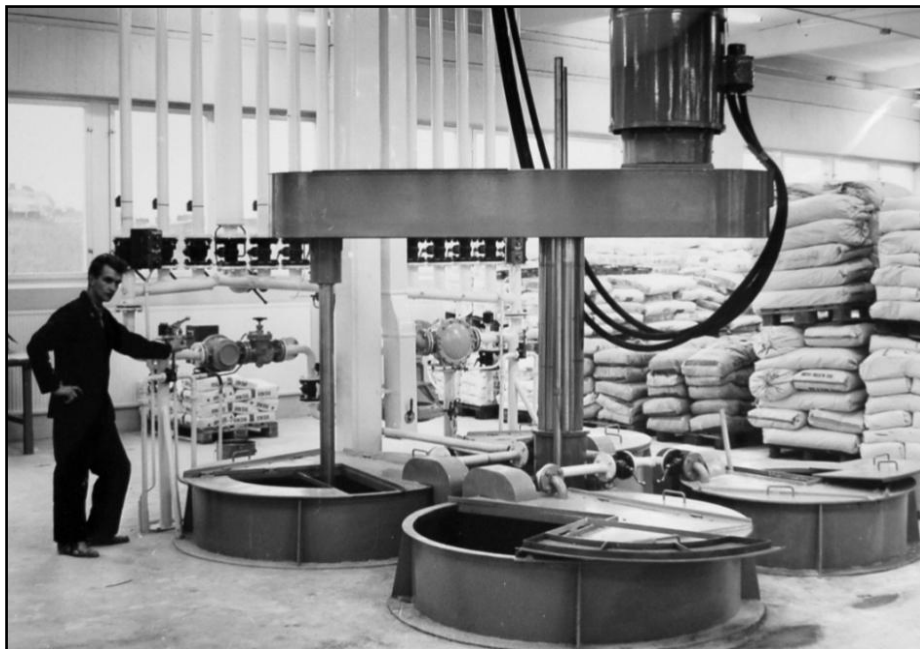
Förblandning med en Lowles-blandare i byggnad 38 på Lövholmen, 1964. De torra råvarorna som användes vid satsningen låg i säckar innan bruket av cisterner kom igång. (Ur Beckers arkiv)
