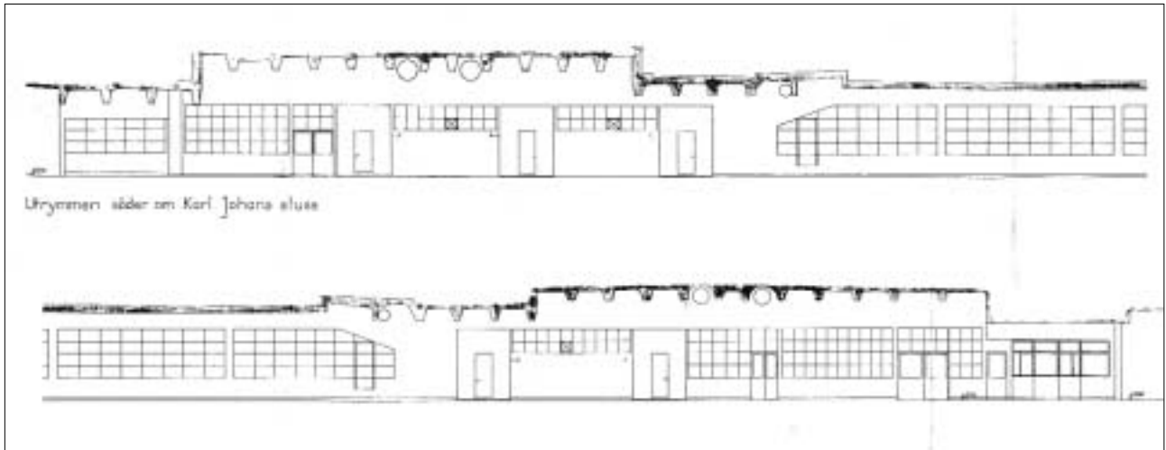
Utsnitt av ritning från 1935 som visar lokalens fasad under Katarinavägen och Skeppsbron, mot norr och Karl Johanslussen. På fasadens yttre sidor hade hamnen sina lokaler, med slussmaskineri och slusskontor (slusskontoret längst ned till höger). Ritningen är delad. BNA, Södermalm 7:85.
