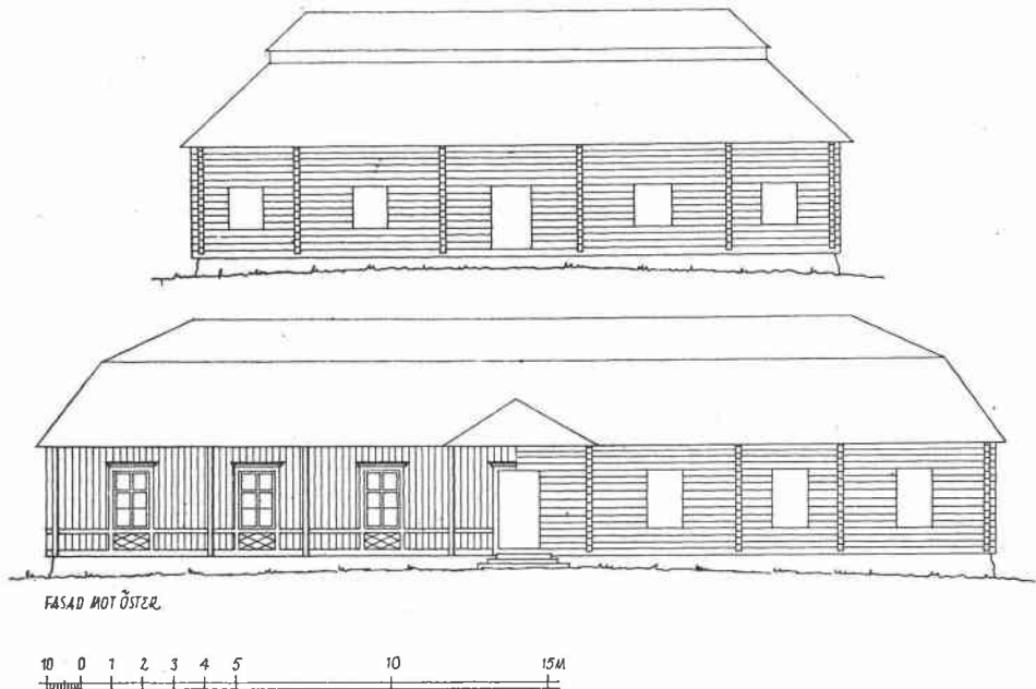
Fig. 6. Skårby. Manbyggnaden. Rekonstruktioner av fasaden mot gårdsplatsen. Övre bilden: Det äldsta timmerhuset; 1:a byggnadsperioden. Nedre bilden: Det äldsta huset har tillbyggt på gavlarna. Högra delen (från åskådaren räknat) visar huset och tillbyggnaden med rödmålade timmerväggar; 2:a byggnadsperioden. Vänstra delen visar timmerfasaden klädd med stående panel; 4:e byggnadsperioden. Rekonstruktioner efter uppmätning av Folke Larcke och Alf Nordström.
