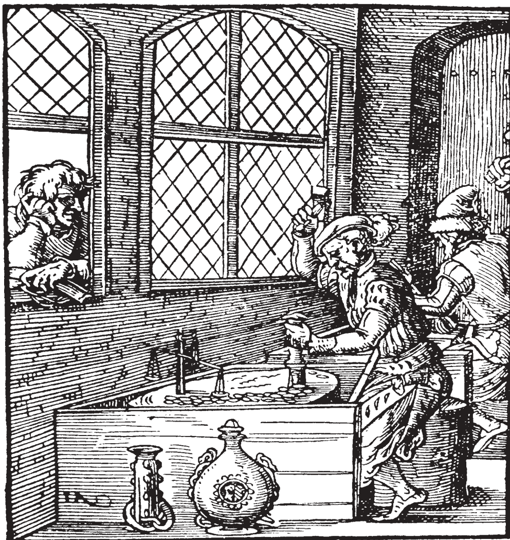
Figur 166. Under mer än 200 år användes hammarprägling för att tillverka mynt. I ett träsnitt från cirka 1560 av H. Amman visas hur tillverkningen gick till. Myntslagningen skedde ofta öppet så att allmänheten kunde kontrollera att allt gick rätt till. Notera även balansvågen (ur Lagerqvist & Nathorst-Böös 1981 s. 255).
